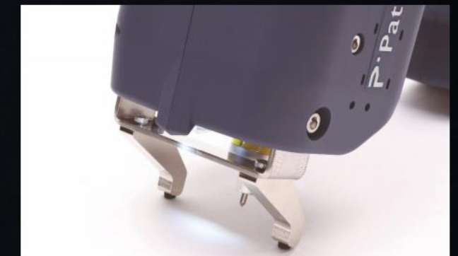
Merkintäjalat monimutkaisille geometrioille
